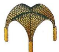
Bóveda de arista.
