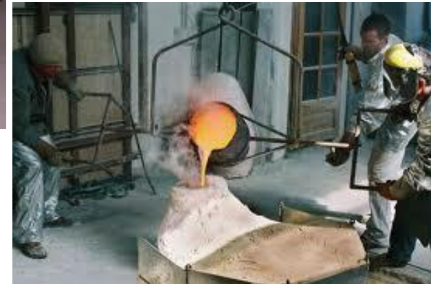
Molde y colado del metal
