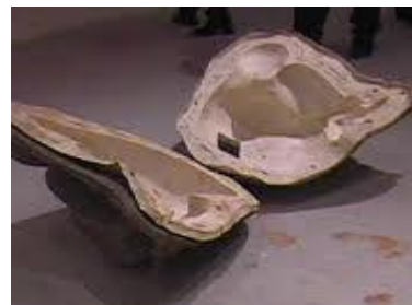
Molde y colado del metal
